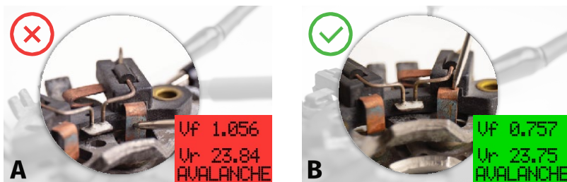
Rysunek 4. Wykonywanie pomiarów: - źle; B) – dobrze
