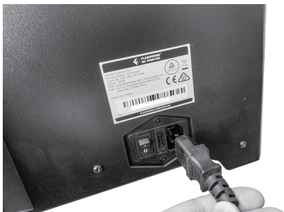
13. 取出电源线，插入打印机背部的电源线接口。
