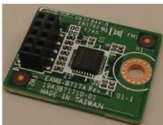
将模块插入到 Box PC IIoT排针上。
