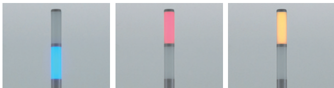
青(点灯): 印刷中 青(点滅): 原稿の読み取り中
