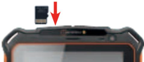
» Aprire il IP-plug dello slot SD.
