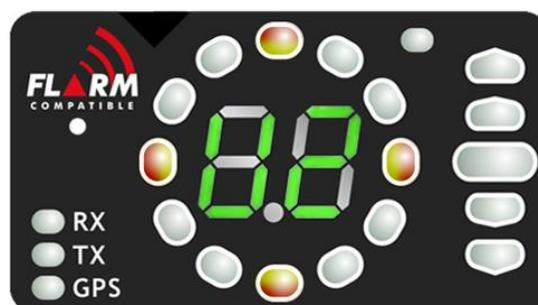
Bei einer langen Berührung (1 Sekunde) mit dem Touchpad wechseln wir zwischen verschiedenen Einstellungen, die eingestellt werden können. Durch kurzes Berühren wird der Wert für die aktuelle Einstellung geändert.
