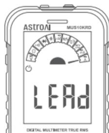
**Note:** c. Il misuratore attiverà la funzione di test corrente quando si inserirà il puntale rosso nella presa 'mA' e quello nero nella presa 'COM' in qualsiasi modalità. Per motivi di sicurezza, l'utente non può premere il pulsante 'AUTO / FUNC' per cambiare le funzioni. Lo strumento emetterà un segnale acustico regolare per ricordare all'utente di utilizzare correttamente la funzione di test corrente.
