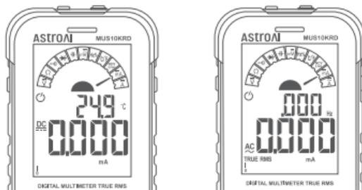
**Note:** a. Durante la misurazione della corrente AC, la frequenza sarà visualizzata contemporaneamente. Durante la misurazione della corrente DC, sullo schermo verrà visualizzata la temperatura ambiente.
