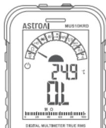
5. Collegare i puntali al circuito da testare (in parallelo) o a entrambe le estremità del resistore.
