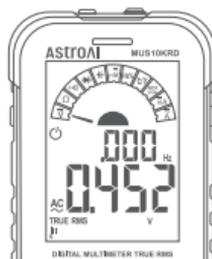
**Nota:** durante la misurazione della tensione AC, la frequenza verrà visualizzata contemporaneamente. Quando si misura la tensione DC, sullo schermo verrà visualizzata la temperatura ambiente.
