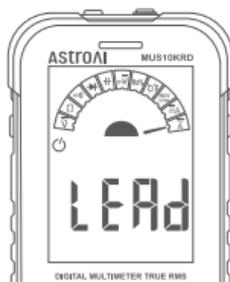
**Note:** c. Il misuratore attiverà la funzione di test corrente quando il puntale rosso è inserito nella presa 10 A e quello nero nella presa 'COM' in qualsiasi modalità. Per motivi di sicurezza, l'utente non può premere il pulsante 'AUTO / FUNC' per cambiare le funzioni. Lo strumento emetterà un segnale acustico regolare per ricordare all'utente di utilizzare correttamente la funzione di test corrente.
