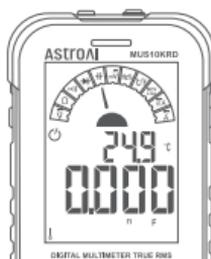
5. Collegare il misuratore con entrambe le estremità del condensatore da testare (in parallelo rispetto al condensatore).
