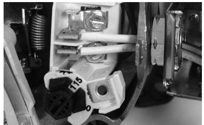
Figura 17 - Tensión configurada para 115 V, tipo cuadrante.
