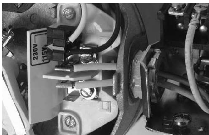
Figure 15 :-Tension réglée à 115 V sur sélecteur à fiche
