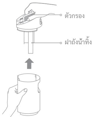
3. ล้างถังน้ำทิ้งกับฝาล้างด้วยน้ำ ใช้แปรงทำความสะอาดสะอาดที่ให้ไปทำความสะอาดผนังด้านในของถัง
