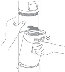
2. Вийміть фільтр з кришки резервуара для брудної води. Зніміть кришку резервуара та вилийте брудну воду.
