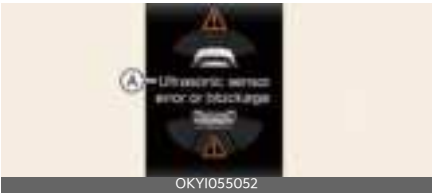
A: Ultrasonic sensor error or blockage
