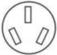
Tomacorriente de 3 hilos (10-50R)
