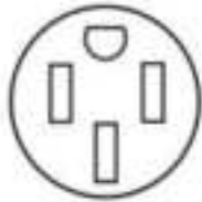
Tomacorriente de 4 hilos (14-50R)
