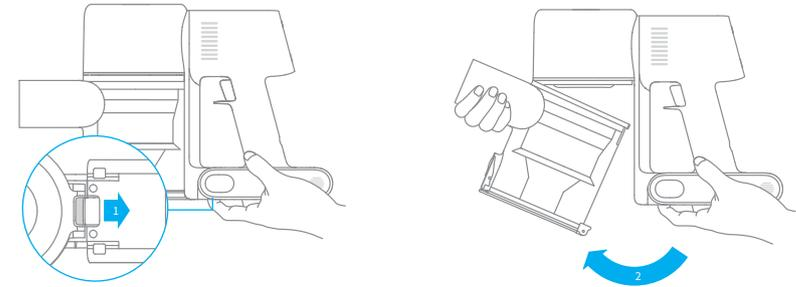
3. Retirez d'abord le préfiltre, puis levez la poignée de l'ensemble cyclone et tournez-la dans le sens inverse des aiguilles d'une montre jusqu'à ce qu'elle ne puisse plus tourner. Tirez ensuite pour soulever l'ensemble cyclone.
