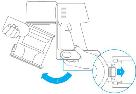
2. Retirez le filtre HEPA de l'aspirateur en tirant dessus, dans la direction indiquée sur le schéma.
