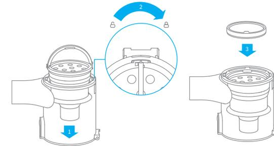
3. Inclinez légèrement le compartiment à poussière pour que son encoche soit alignée avec le clip sur l'aspirateur. Enfoncez délicatement le compartiment à poussière jusqu'à entendre un déclic.
