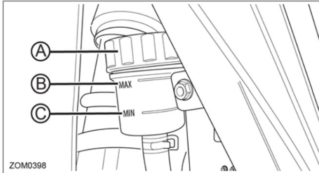
Controllare il livello del liquido del freno posteriore attraverso l'alloggiamento del serbatoio. L'alloggiamento del serbatoio si trova all'interno, sul telaio dietro il paratacco. Se il livello del liquido è al di sotto dell'indicatore inferiore del minimo MIN(C), aggiungere liquido dei freni fino al raggiungimento dell'indicatore superiore **MAX** (B). Non riempire in modo eccessivo.
