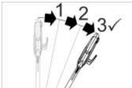
Slika: Otkočivanje sklopke za uključivanje/isključivanje
