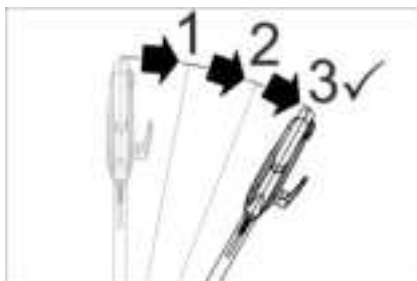
Imagine: Deblocarea comutatorului principal Pornire/Oprire
