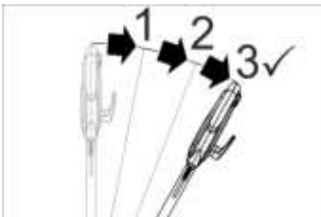
Figura: Desbloqueio do interruptor ON/OFF
