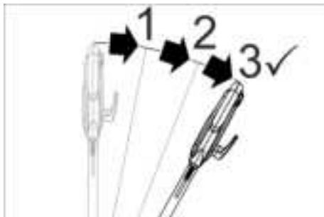
Рисунок: Разблокировка выключателя ВКЛ./ВЫКЛ.
