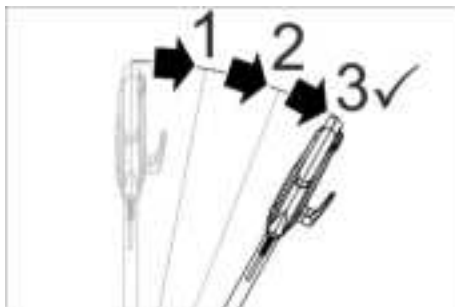
Rysunek: Odblokowanie włącznika / wyłącznika
