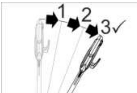
Afbeelding: ontgrendeling van de AAN/UITschakelaar
