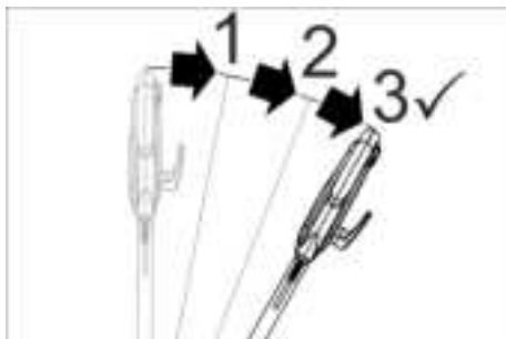
Figura: Sblocco dell'interruttore ON/OFF
