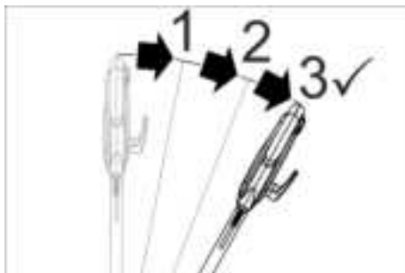
Сурет: ҚОСУ/ӨШІРУ қосқышының құлпын ашу
