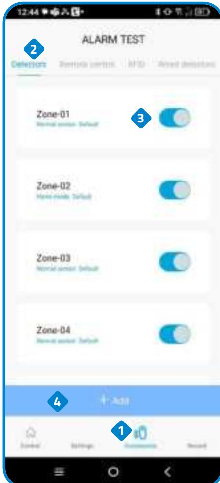
3 Permite ativar ou desativar um sensor ou zona previamente adicionados.
