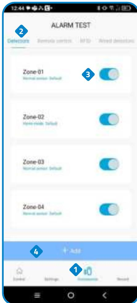
3 Permite activar o desactivar un sensor o zona ya agregado previamente
