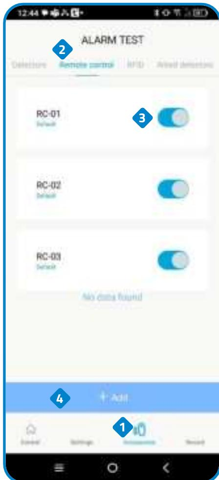
3 Permite activar o desactivar un mando a distancia agregado previamente.
