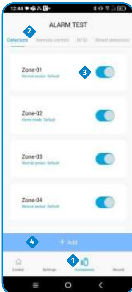
3 Ermöglicht die Aktivierung oder Deaktivierung eines zuvor hinzugefügten Sensors oder einer Zone.
