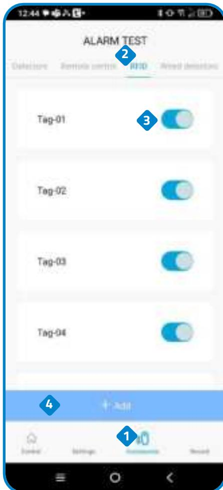
3 Ermöglicht die Aktivierung oder Deaktivierung eines zuvor hinzugefügten Schlüsselanhängers oder Tags.
