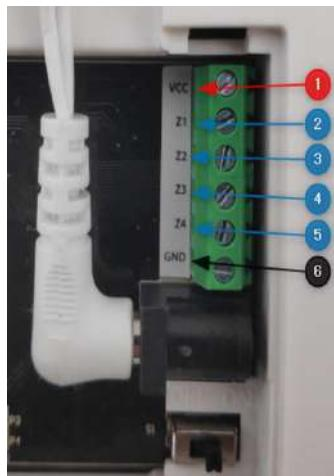
Conexão de um PIR existente.
