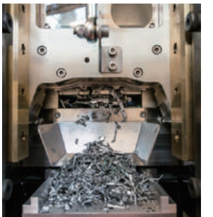
オンサイト HDD 破砕（シュレッド）
