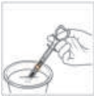
그림 4 - 두 번째 딸깍 소리가 나는 위치 (완전히 뺀 위치)
