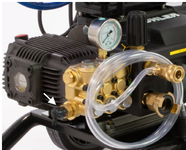
Abb. 19: Überdruckventil mit Pfeil markiert
