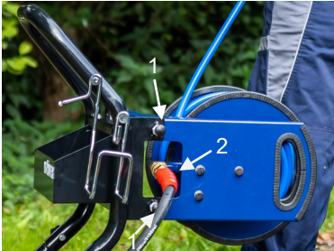
Abb. 2: Bolzen an Trommelhalterung mit Pfeil markiert
