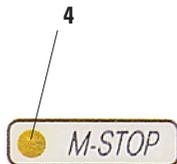
本体コミュニケーションディスプレイの **M-STOP** フィールドの黄色の LED (4) が点灯する場合、機械的なハンドホイールロック、またはハンドホイールブレーキ（図 3 の 3）が作動しています。
