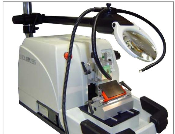
図 72、オプションのアクセサリ（マグニファイヤーと光ファイバーライトガイド）が取り付けられたライカ回転式ミクロトム
