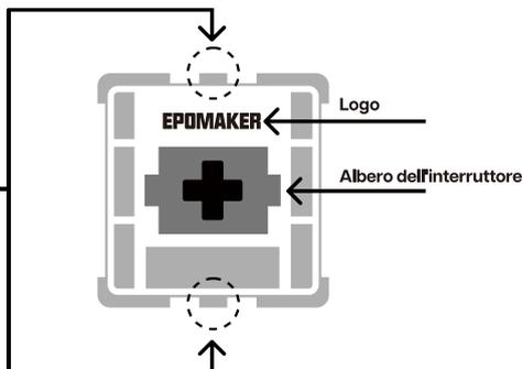
L'utensile per l'estrazione dell'interruttore si allinea verticalmente alla clip dell'interruttore per fissare la plastica dell'interruttore alla piastra.
