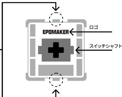
スイッチのヒントと軸本体の上端と下端のスイッチに揃って、強力してスイッチをインストールする
