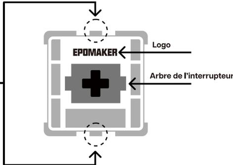
L'outil d'extraction de l'interrupteur s'aligne verticalement sur l'interrupteur pour déclipser le plastique qui fixe l'interrupteur à la plaque.
