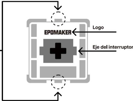
La herramienta de extracción de interruptores se alinea verticalmente con el interruptor para soltar el plástico que asegura el interruptor a la placa.
