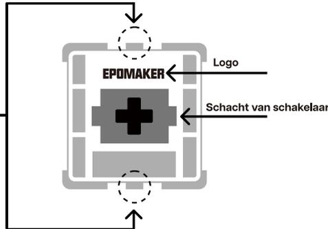
Het gereedschap voor het uittrekken van schakelaars richt zich verticaal op de schakelaar om het plastic los te maken waarmee de schakelaar aan de plaat is bevestigd.
