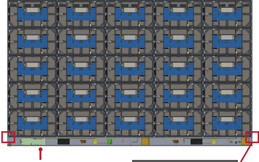
Sistem Kontrol Panosu
