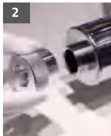
Verwijder de gesloten moer van het gesloten uiteinde van de reactorkamer.
