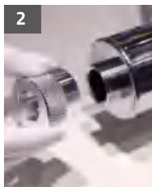
2 Retire la tuerca del extremo cerrado de la cámara del reactor.
