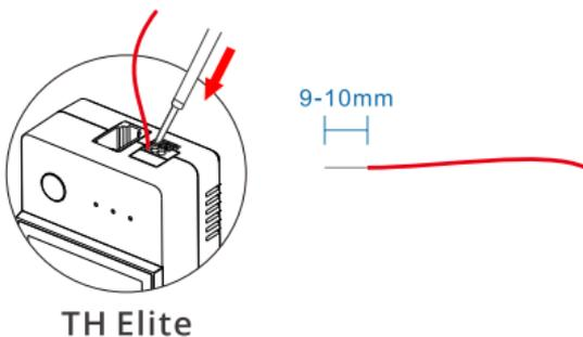
按下接线孔对应上方的白色按钮同时将线材插入，松开按钮即可。
