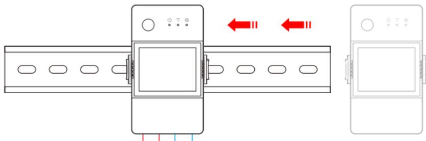
先把导轨固定在设备需要安装的位置,再把设备底座卡扣对准导轨侧边滑动即可。
