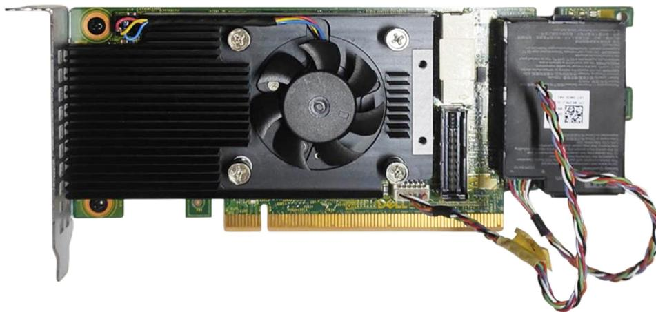
図 2. PERC H965i アダプター-detachable バッテリーを搭載した PERC H965i アダプター
