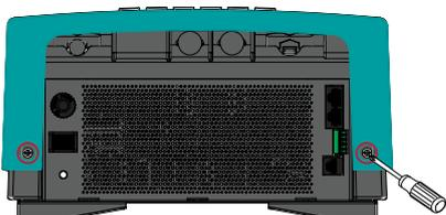
**Etape 7.** Branchez les câbles CA aux bornes à visser. Fixez les câbles avec un dispositif de décharge de traction.
