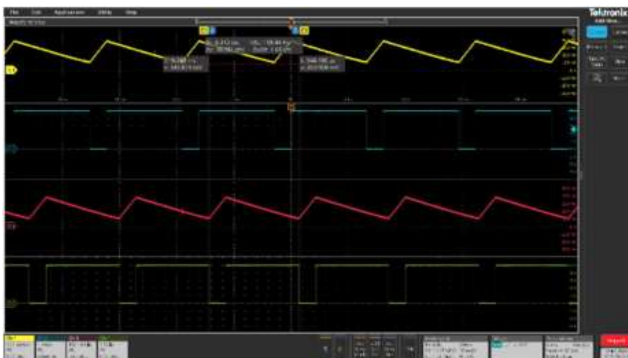
Figure 23. RS_LDO2 without Wi_LDO2 for VO2 output (VO2= 0.8V F=158.44Hz)
