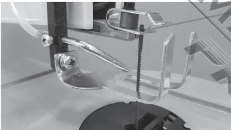
**Λειτουργία με λεπίδες με ακίδες στήριξης**
