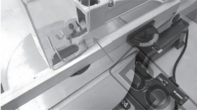
Αν χρησιμοποιείτε λεπίδα κοπής με ακίδες μπορείτε να ρυθμίσετε το εργαλείο για κοπή σε πλάγια θέση και να χρησιμοποιήσετε τον οδηγό συνδέοντας τον στην πίσω ράγα οδηγό.
