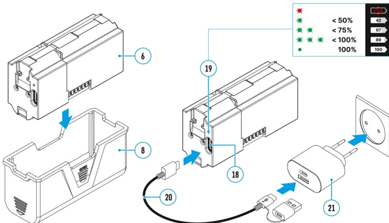
1. Retire la cubierta protectora **(8)**.
