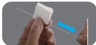
4. Pliez un chiffon doux imbibé de produit nettoyant sur l'aiguille, essuyez les résidus de peinture.
