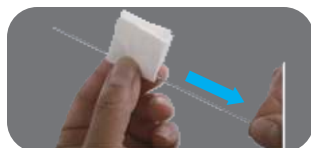
4. 針の上にクリーナーで湿らせた柔らかい布を折り、残りの塗料を拭き取ります。
