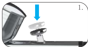
Нажмите на основной рычажок для подачи воздуха.
