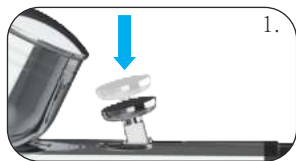
空気のメインレバーを押し下げます。
