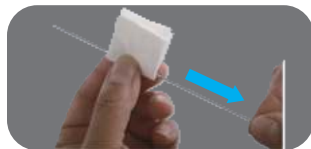
4. Doblar un paño suave humedecido con limpiador sobre la aguja, limpiar los restos de pintura.
