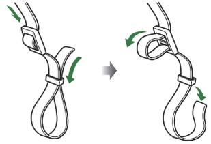
2. Führen Sie das Ende des Trageriemens durch die Trageriemenöse und zurück durch die Befestigungsschleife.
