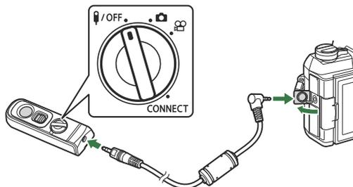
Drehen Sie das Modus-Einstellrad der Fernbedienung auf **OFF** und schließen Sie die Fernbedienung über das mitgelieferte Kabel an die Kamera an.
