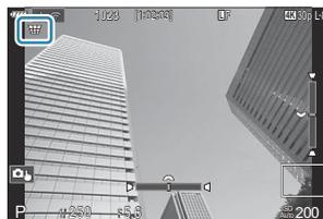
1. Wählen Sie den Bildausschnitt aus und passen Sie die Keystone-Korrektur an, während das Motiv auf dem Bildschirm angezeigt wird.
