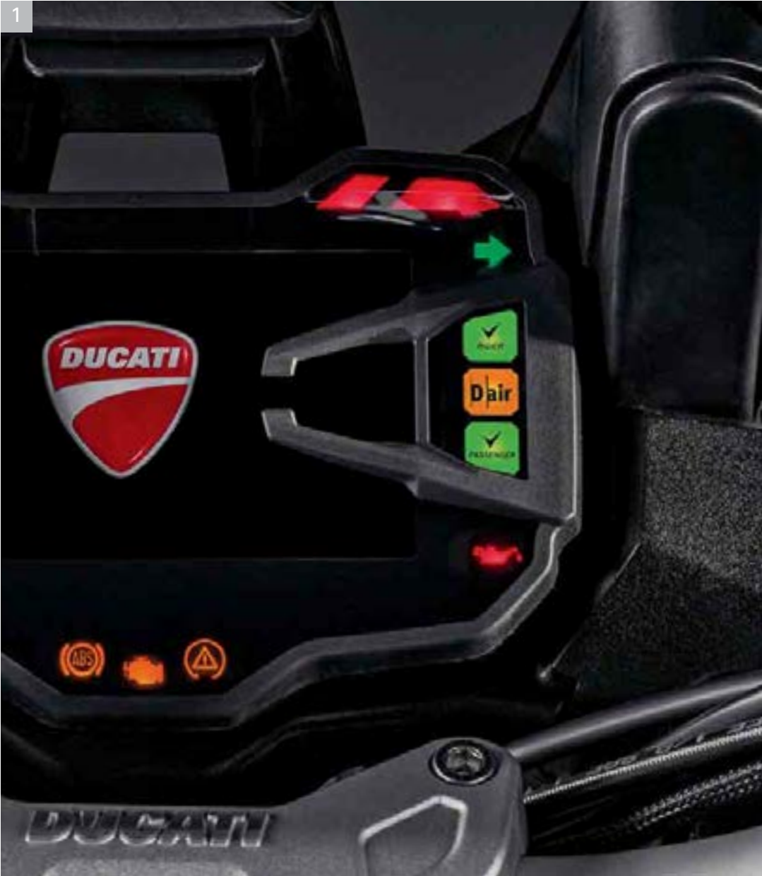
1 Spie di controllo del sistema D|air® integrate nel display full-TFT a colori
