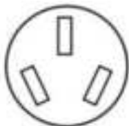
Tomacorriente de 3 hilos (10-50R)
