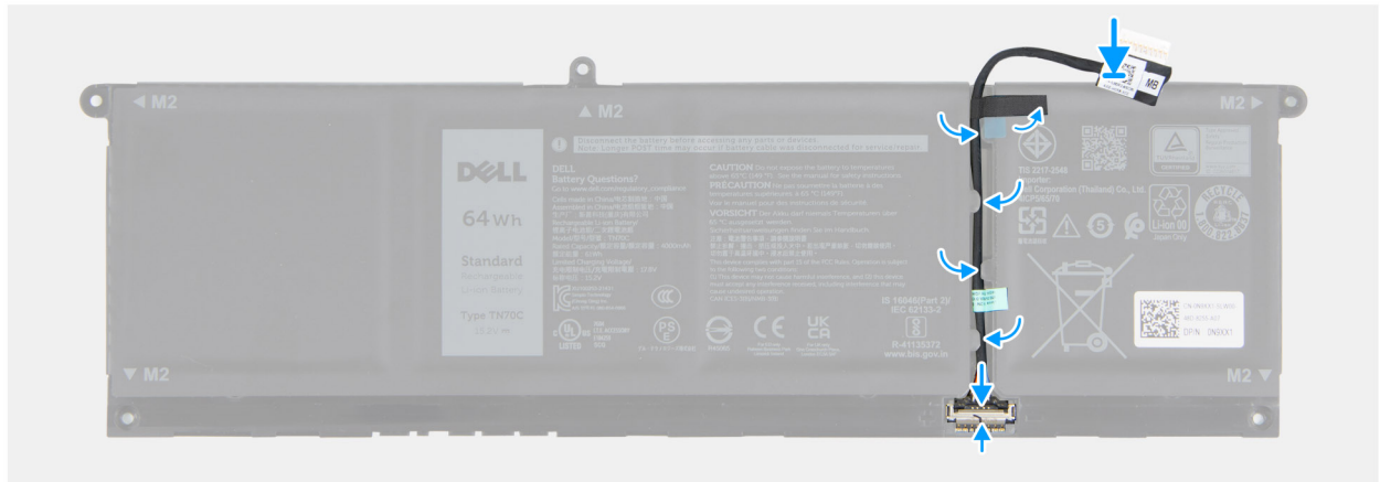
图 19: 安装电池线缆
