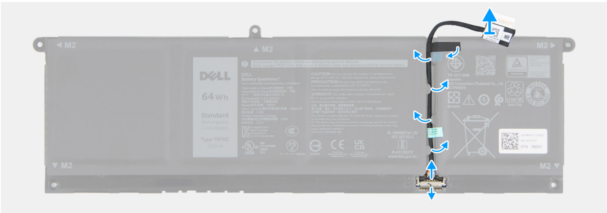
图 18: 卸下电池线缆
