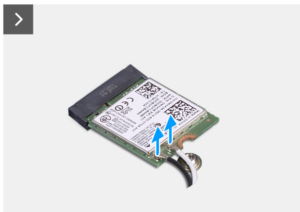
图 24: 卸下无线网卡
