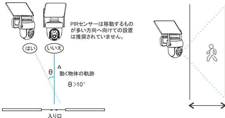
カメラを設置する際、PIRセンサーは動く物体に垂直に設置しないでください。全ての動作を捉えるには、カメラを10度以上傾けることが推奨されています。
