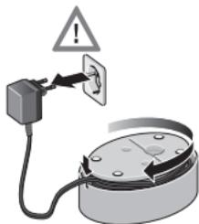
ケーブルの全長が必要ない場合は接続ケーブルの一部をケーブル収納部 9 に収納することができます。
