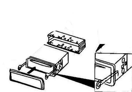
Para remover, insira a chave entre o aparelho e a cinta de fixação e puxe o aparelho do painel
