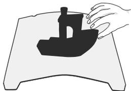
1. A. Sobald der Druckvorgang beendet ist, warten Sie, bis die Plattformplatte abgekühlt ist, bevor Sie die Druckplattform mit dem angebrachten Modell entfernen;
