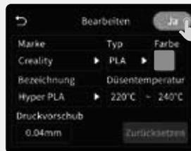
Klicken Sie auf „Filament“ → „Bearbeiten“, dann setzen Sie die Filamentmarke, Typ, Name und Farbe ein und klicken schließlich auf OK, um die Einstellungen zu speichern (RFID-Verbrauchsmaterialien erfordern keine Bearbeitung);
