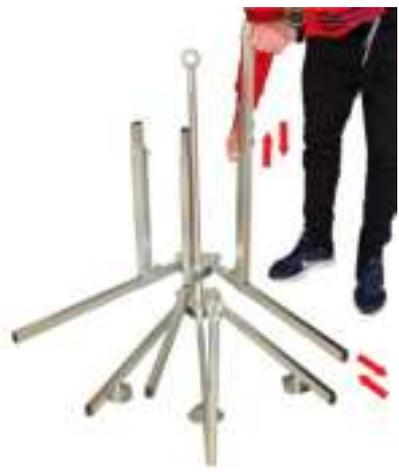
3) Inserire le aste di altezza e regolarle in base a altezza e diametro del rotolo.
