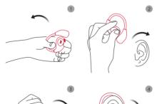
开机状态下连续5击耳机触控键(双耳同时),耳机将自动关机,恢复 出厂设置。耳机放入充电盒再取出,耳机重新开机,进入配对模式。
