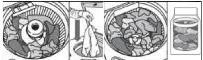
Pour un meilleur rendement, déposer les articles de lavage de façon uniforme autour de la paroi du panier. Ne pas poser d'articles dans le sens de la longueur.
