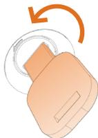
Drehen Sie den Schlüssel und entnehmen Sie die Batterie.
