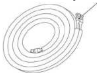
Conectores de la tubería de refrigerante (ambos extremos)
