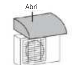
Construire un abri pour protéger l'unité
