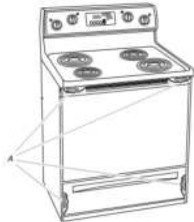
A. La plaque signalétique est située sur le châssis derrière un coin supérieur de la porte ou d'un côté du tiroir.
