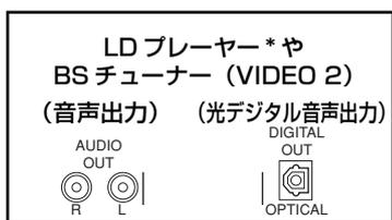
\* AC-3RF出力端子のついているLDプレーヤーを接続する場合は、AC-3RFデモジュレーターを通してデジタル入力端子に接続してください。
