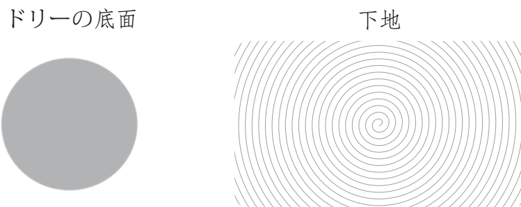
c) 接着剤層剥離
