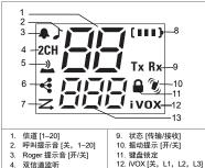
注意:按下最后一个按键后,对讲机屏幕将变暗5秒。出于节省电池电量的目的,LED指示灯将闪烁且再过5秒后对讲机屏幕将关闭。按下任何按键(手电简按键除外)可恢复显示屏。
