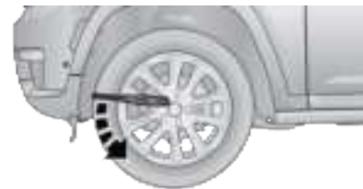
Loosen Lug Nuts
