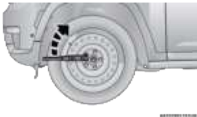
Tighten Lug Nuts
