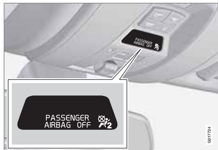
Indikering i takkonsolen som visar att passagerarplatsens krockkudde är avaktiverad.
