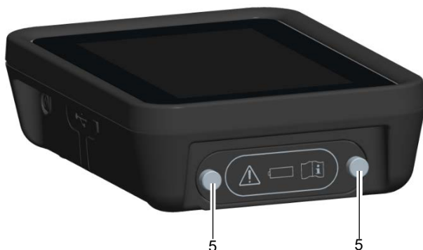
4 pav. „ADTSTOUCH“ baterijos skyrius
